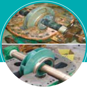
Rivestimenti protettivi e implemento energetico pompe
