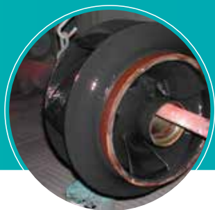
Ripristino e rivestimento apparecchiature rotanti
