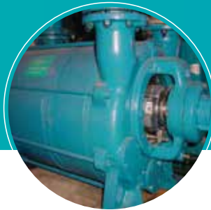
Ricondizionamento e rivestimento pompe vuoto ad anello liquido
